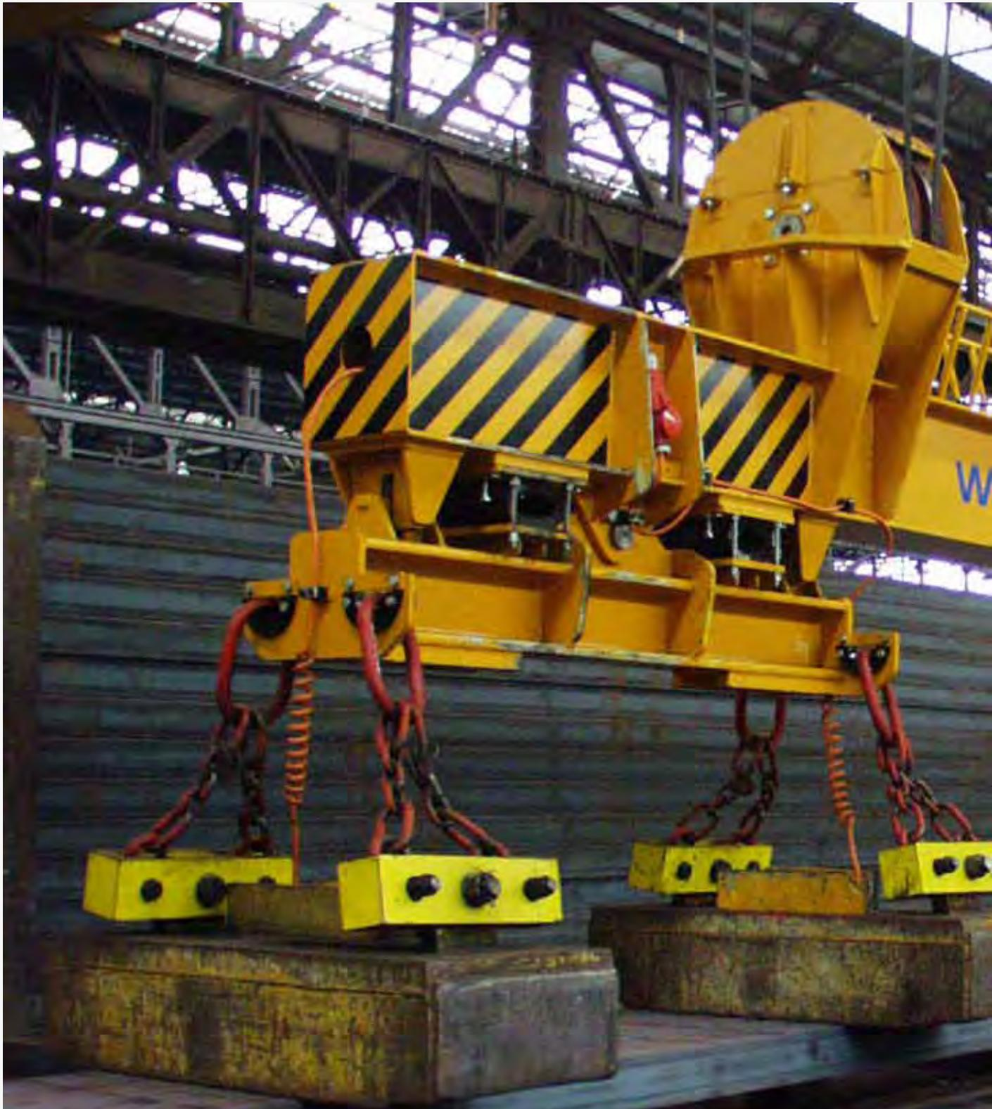
Traverse mit gelenkig aufgehängten Magneten für den Transport von Brammen, Bechen und Bündeln.
