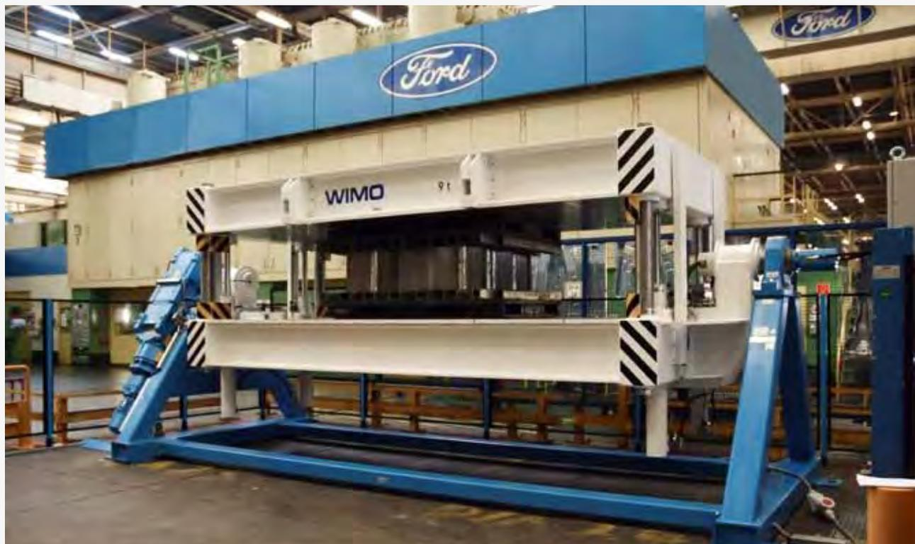
Wendeeinrichtung für automatisches 180°-Wenden palettierter, nicht abgebundener Platinenstapel. Mittels WIMO-Spezialrungen können auch mehrere Platinenstapel gleichzeitig gewendet werden. Einfache Bedienung durch automatische Kontrollen und Einstellungen. Beladung mittels Stapler. Die Beschickung und Entladung des Wenders wird jeweils an seiner Vorderseite durchgeführt. Die Klemmung der palettierten Platinenstapel erfolgt hydraulisch, das Wenden motorisch.
