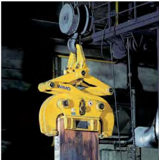
Blockzange in mechanischer Scherenbauweise mit automatischer Offenhalteeinrichtung für vertikalen Transport
