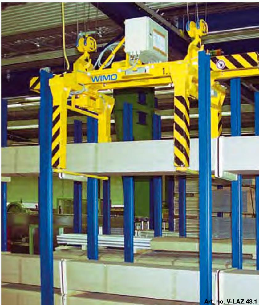
**Bündelzange mit motorisch längsverstellbaren Greifeinheiten und Aufnahmepratzen-Drehantrieb**
