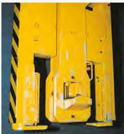
Äußere Aufnahmepratzen in Greifposition. Innere Aufnahmepratzen eingeklappt
