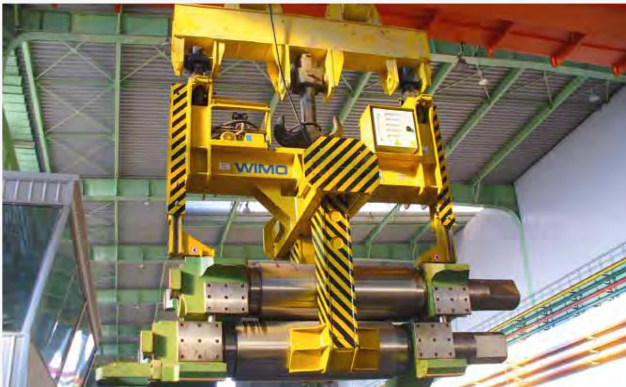
Arbeitswalzenzange am Ballen greifend, mit Spindeltrieb und hydraulisch höhenverstellbaren Sicherungen gegen Verdrehen der Einbaustücke. Für den wahlweisen Transport von ein oder zwei Arbeitswalzen mit Einbaustücken sowie von einer Arbeitswalze ohne Einbaustücke.
