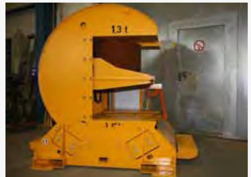
**3-Arm-Zange für Scheibentransport mit manueller Bedienung. Synchroner Zangenarmverstellung durch zentrales Getriebe und Gewindespindeln.**
