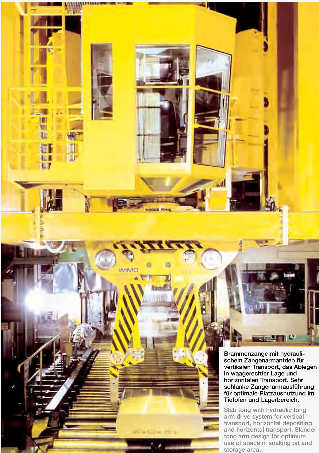
Brammenzange mit hydraulischem Zangenarmtrieb für vertikalen Transport, das Ablegen in waagerechter Lage und horizontalen Transport. Sehr schlanke Zangenarmausführung für optimale Platzausnutzung im Tiefofen und Lagerbereich.
