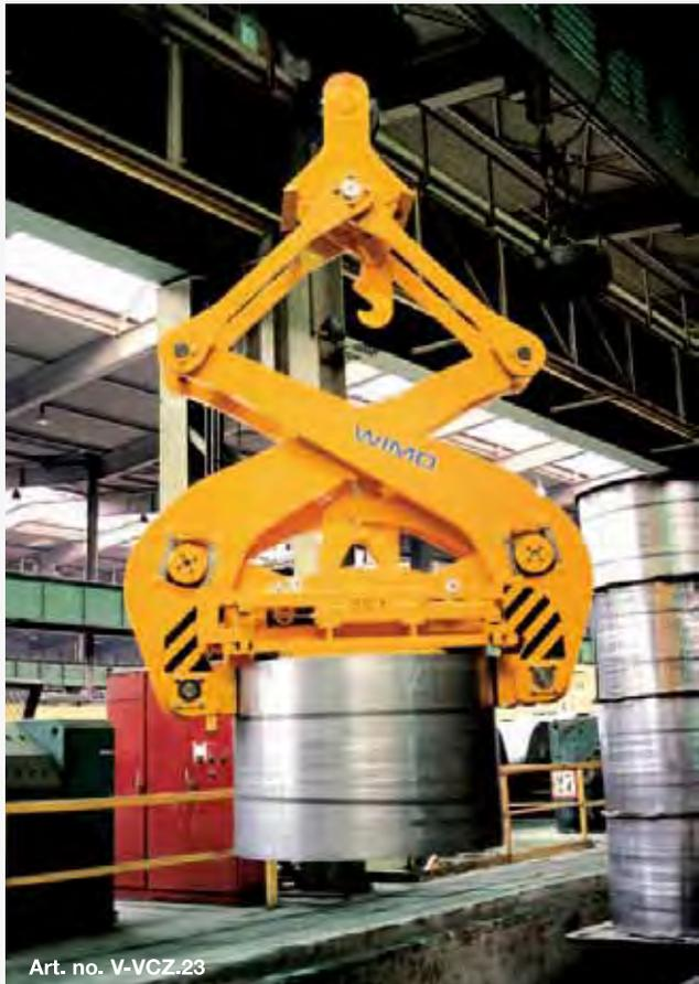
**Vertikal-Coilzange in mechanischer Ausführung mit doppelseitiger Lastaufnahme**
