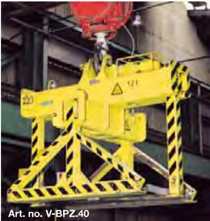
Blechkpaketzange mit vier motorisch angetriebenen Zangenarmen für den Transport niedriger Blechkpaketstapel aus besonders dünnen Blechen.
