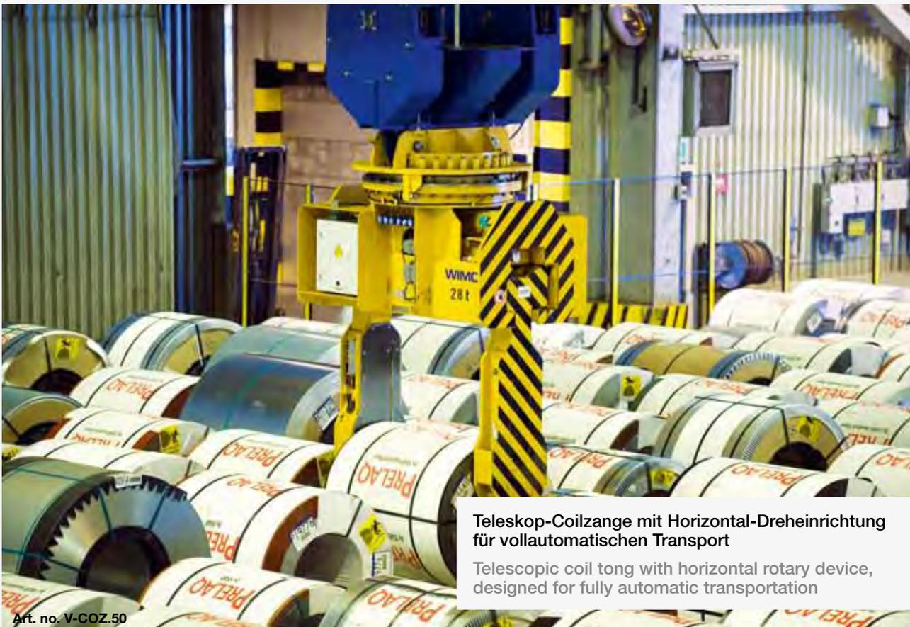
**Teleskop-Coilzange mit Horizontal-Dreheinrichtung für vollautomatischen Transport**
