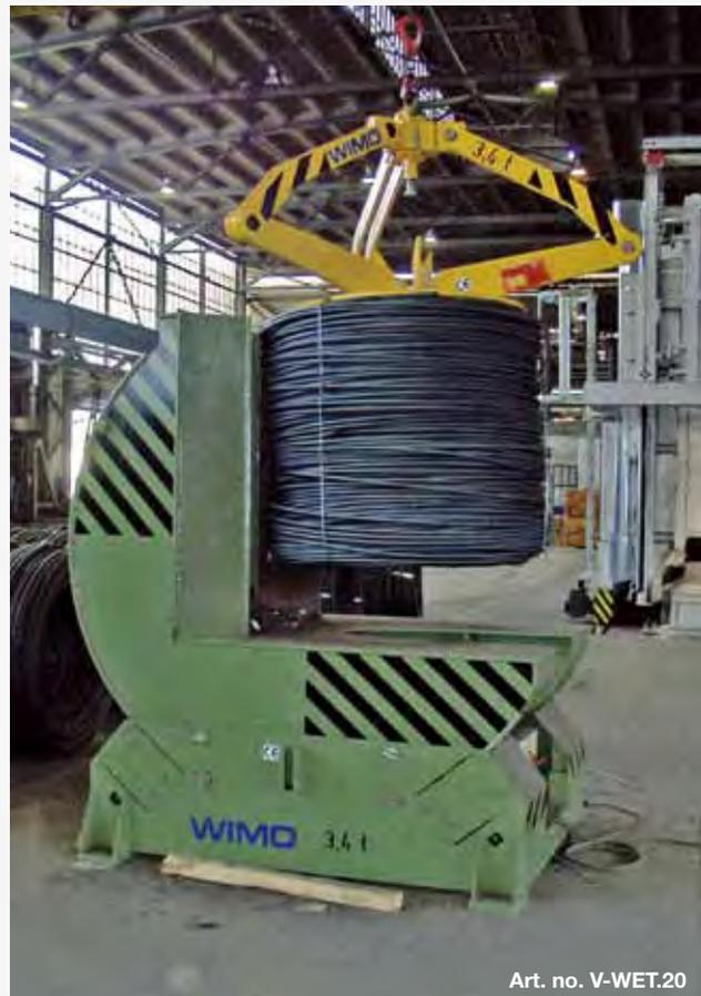
Drahtcoilwendeeinrichtung in Wenderradausführung, motorisch angetrieben, Wendebereich 90°. Mit mechanischer Drahtcoilzange in Dreiarmscherenbauweise
