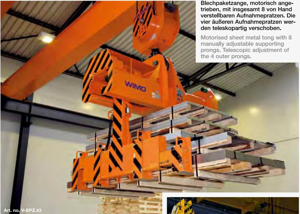
Blechkpaketzange, motorisch angetrieben, mit insgesamt 8 von Hand verstellbaren Aufnahmepratzen. Die vier äußeren Aufnahmepratzen werden teleskopartig verschoben.
