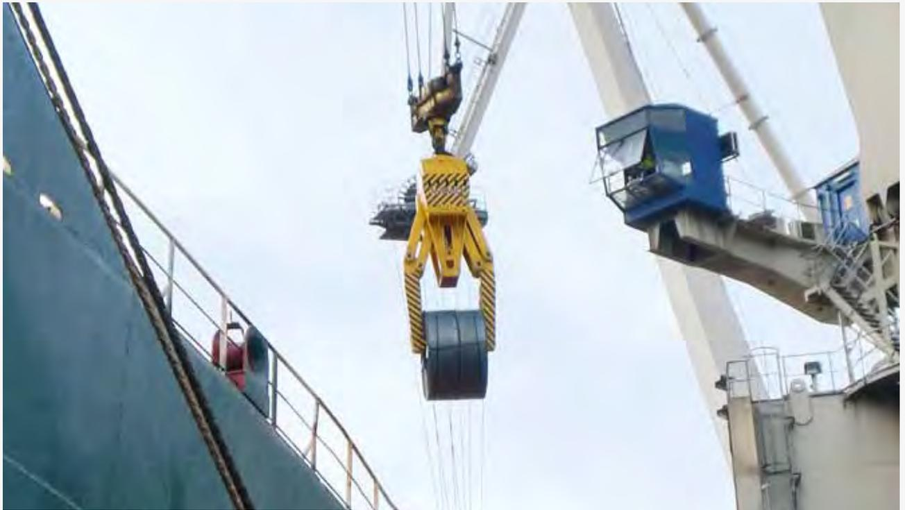
**Parallelogramm-Coilzange, hydraulisch angetrieben, mit Zusatzeinrichtungen für schonenden Materialumschlag im Hafenbetrieb**
