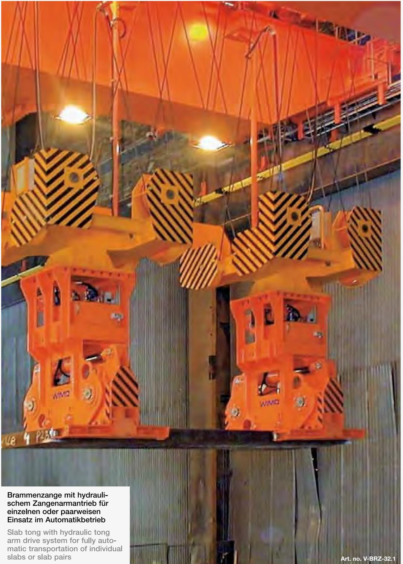
**Brammenzange mit hydraulischem Zangenarmtrieb für einzelnen oder paarweisen Einsatz im Automatikbetrieb**
