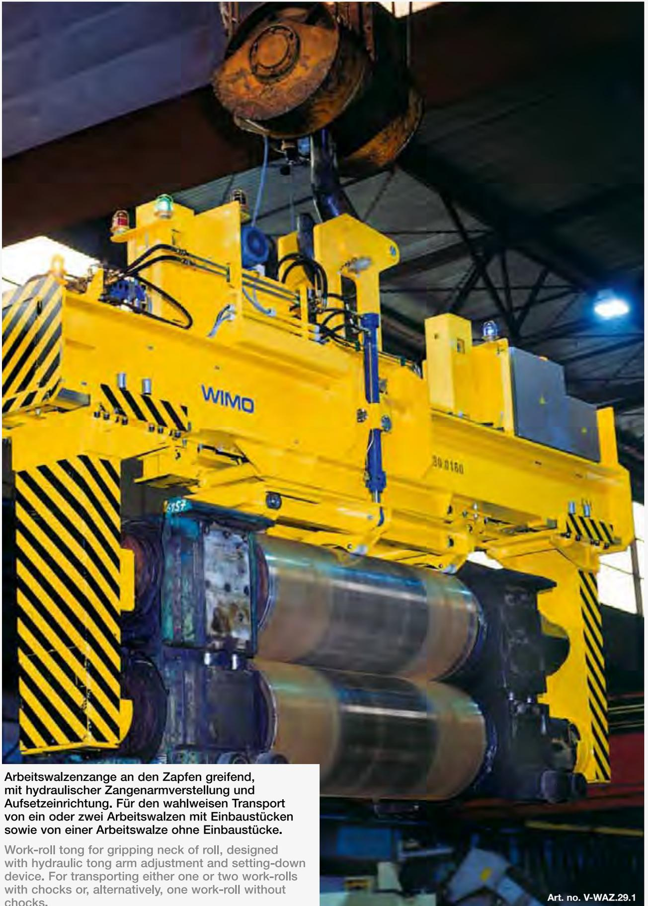
Arbeitswalzenzange an den Zapfen greifend, mit hydraulischer Zangenarmverstellung und Aufsetzeinrichtung. Für den wahlweisen Transport von ein oder zwei Arbeitswalzen mit Einbaustücken sowie von einer Arbeitswalze ohne Einbaustücke.
