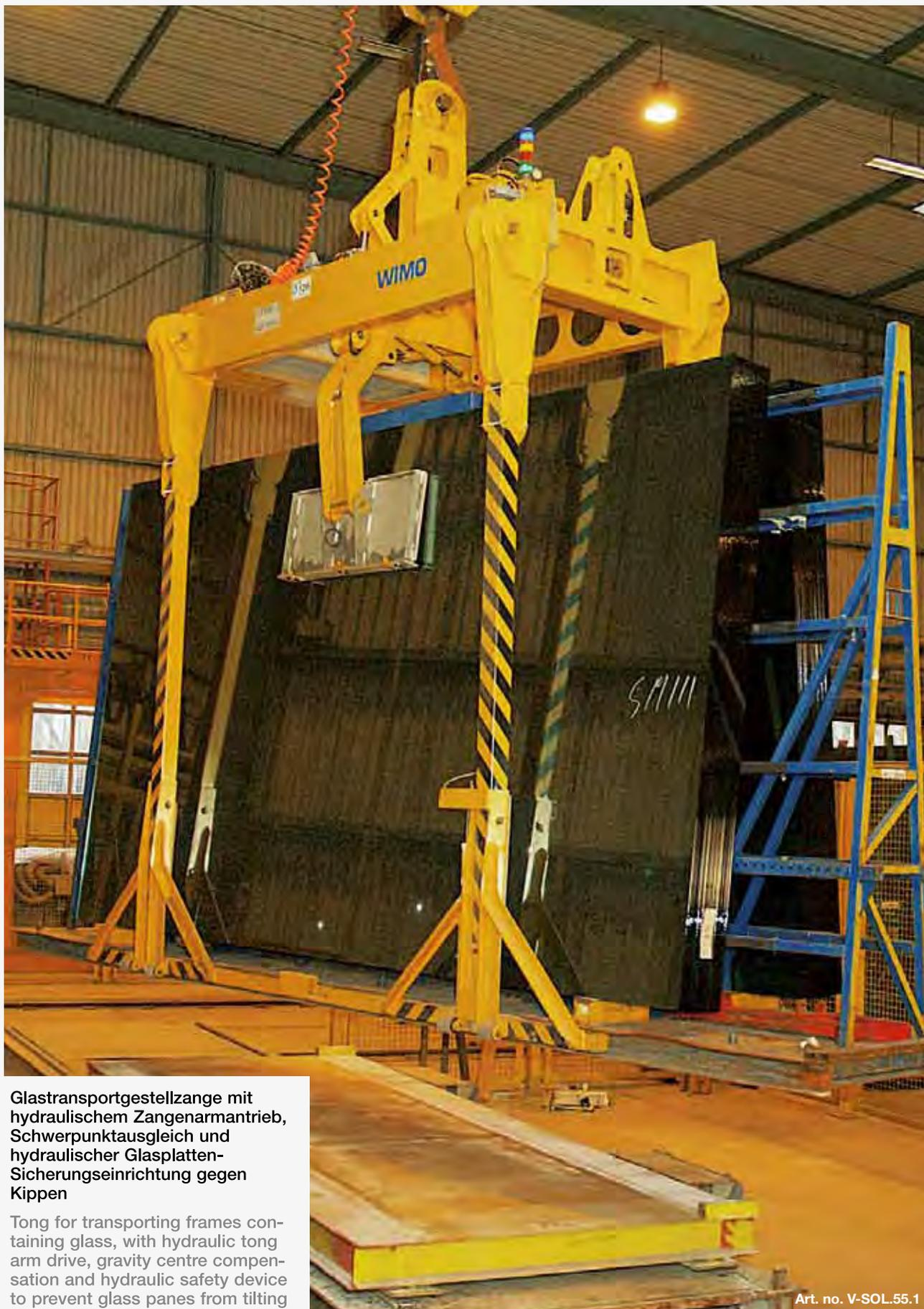
Glastransportgestellzange mit hydraulischem Zangenantrieb, Schwerpunktausgleich und hydraulischer Glasplatten-Sicherungseinrichtung gegen Kippen
