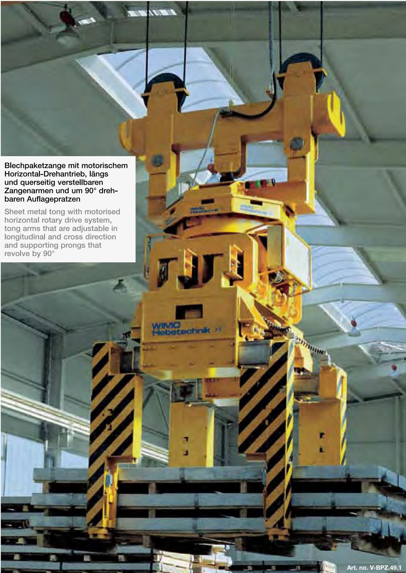
Blechkupfzange mit motorischem Horizontal-Drehantrieb, längs und querseitig verstellbaren Zangenarmen und um 90° drehbaren Auflagepratzen
