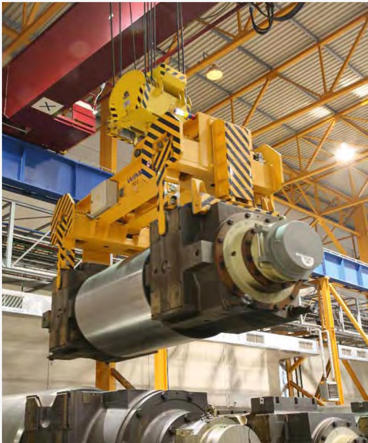
**Stützwalzenzange mit in Querrichtung motorisch verstellbaren Zangenarmen. Die Lastaufnahme erfolgt mittels 4 Dornen an den Bohrungen der Einbaustücke.**
