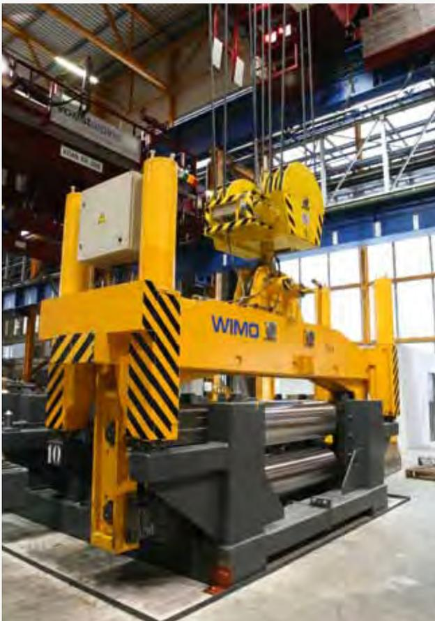
Arbeitswalzenzange am Zapfen greifend, mit hydraulischer Zangenarmverstellung und vier Aufsetsäulen. Für das Einbringen und Entnehmen von ein oder zwei Arbeitswalzen aus Gestellen.
