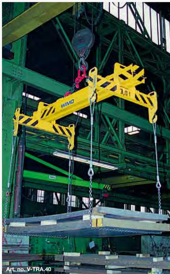
Auslegertraverse mit vier längs- und querverstellbaren Anhängerbügeln
