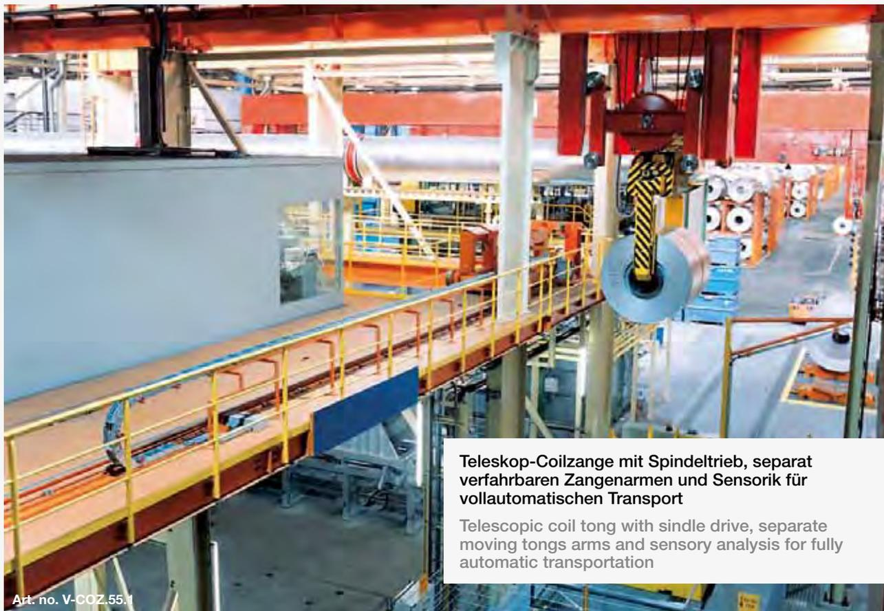
**Teleskop-Coilzange mit Spindeltrieb, separat verfahrbaren Zangenarmen und Sensorik für vollautomatischen Transport**
