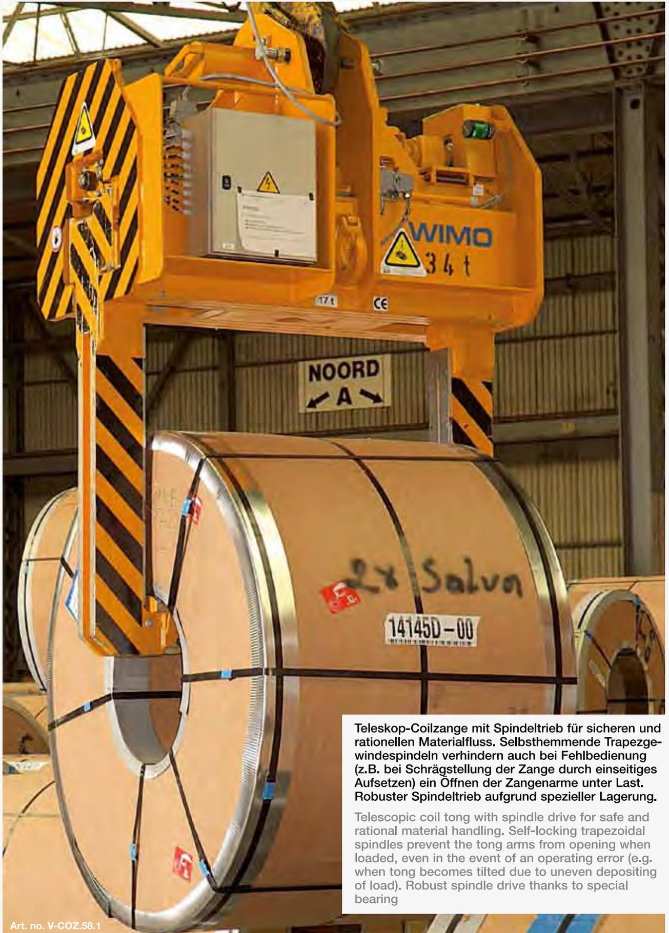
Teleskop-Coilzange mit Spindeltrieb für sicheren und rationellen Materialfluss. Selbsthemmende Trapezgewindespindeln verhindern auch bei Fehlbedienung (z.B. bei Schrägstellung der Zange durch einseitiges Aufsetzen) ein Öffnen der Zangenarme unter Last. Robuster Spindeltrieb aufgrund spezieller Lagerung.
