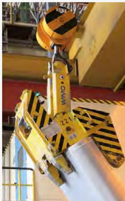
**Brammen-Wendezange in mechanischer Ausführung für senkrechten Transport und das Ablegen in waagerechter Lage**
