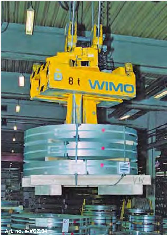
**Coil-Unterfasszange mit motorischem Zangenarmtrieb**
