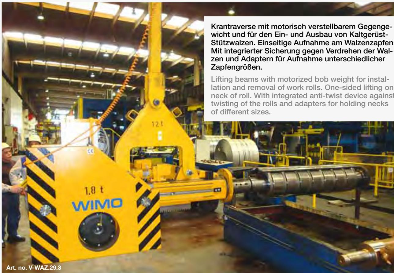
Krantraverse mit motorisch verstellbarem Gegengewicht und für den Ein- und Ausbau von Kaltgerüst-Stützwalzen. Einseitige Aufnahme am Walzenzapfen. Mit integrierter Sicherung gegen Verdrehen der Walzen und Adaptern für Aufnahme unterschiedlicher Zapfengrößen.
