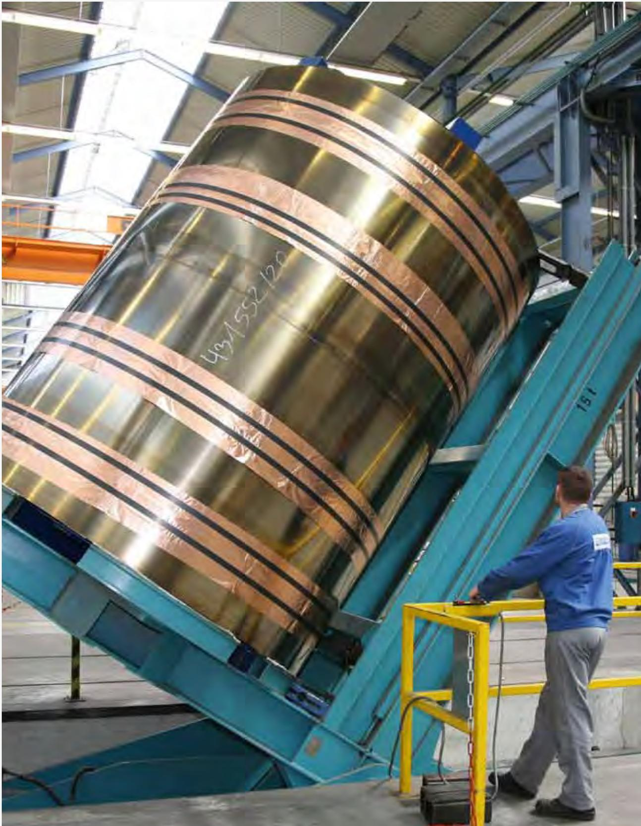
Coilwendeeinrichtung, hydraulisch angetrieben, Wendebereich 90°. Auflageplatten hydraulisch verstellbar. Im Hallenboden versenkt.
