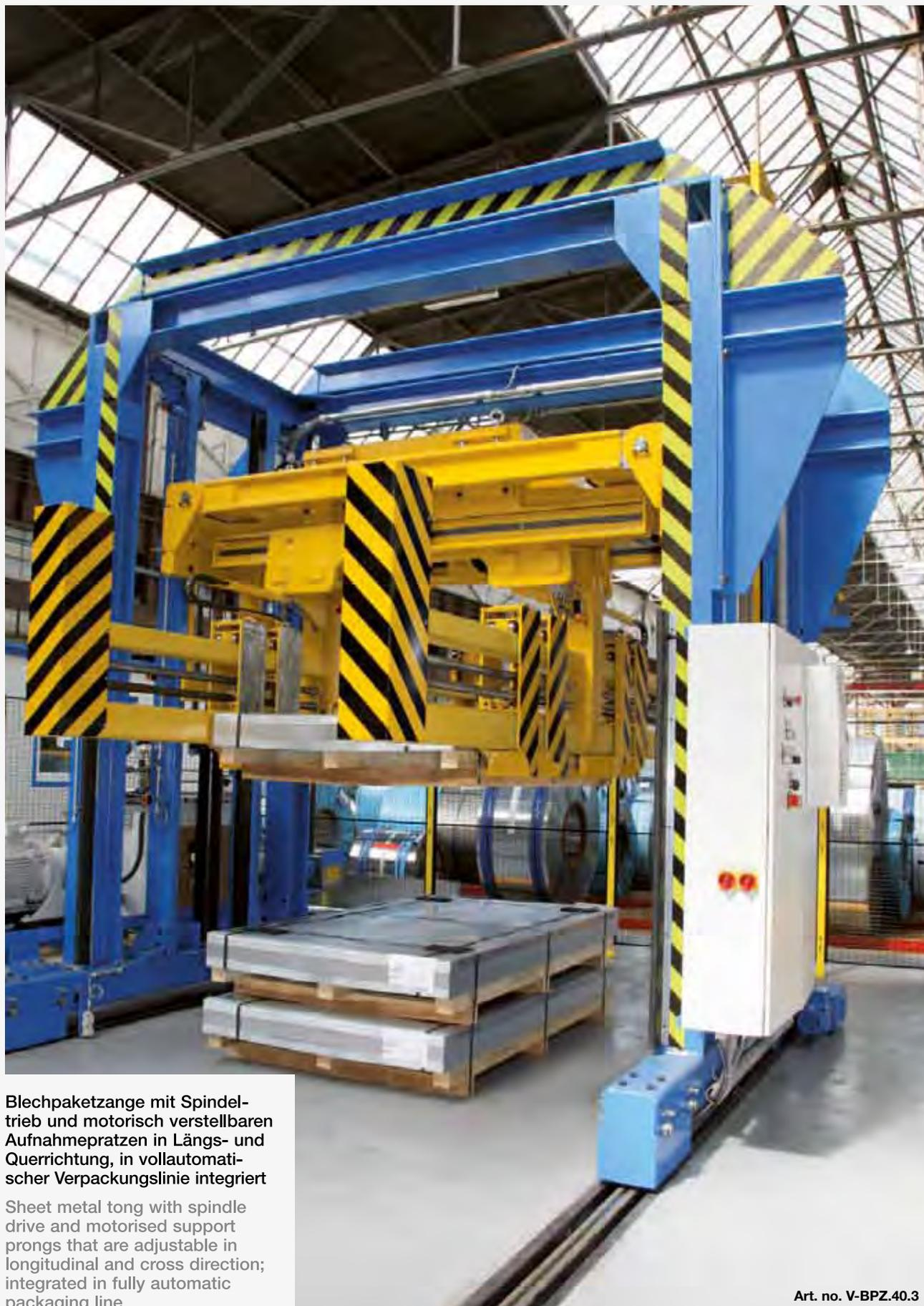
**Blechpaketzange mit Spindeltrieb und motorisch verstellbaren Aufnahmepratzen in Längs- und Querrichtung, in vollautomatischer Verpackungslinie integriert**
