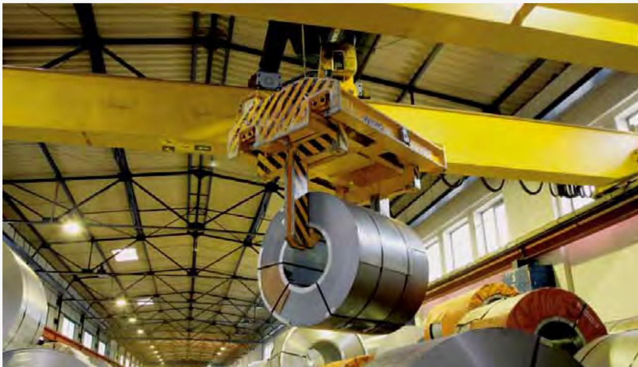
Teleskop-Coilzange mit Spindeltrieb in besonders niedriger Bauweise
