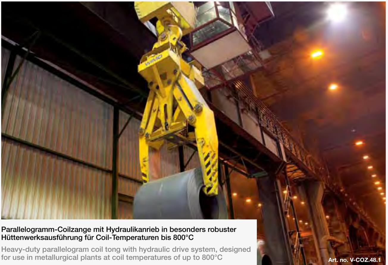
**Parallelogramm-Coilzange mit Hydraulikantrieb in besonders robuster Hüttenwerksausführung für Coil-Temperaturen bis 800°C**
