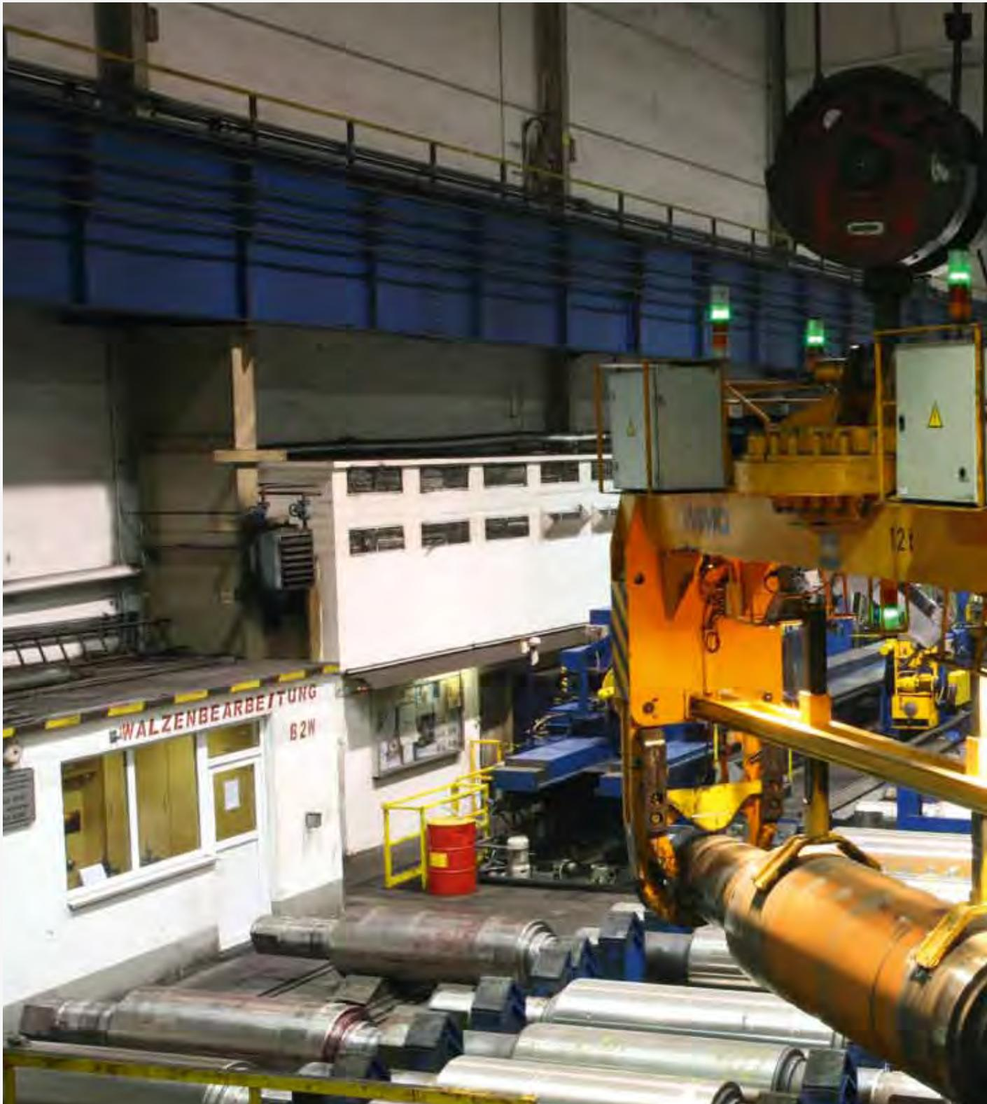
Arbeitswalzenzange am Zapfen greifend, mit Aufsetzeinrichtung und Horizontal-Dreheinrichtung.
